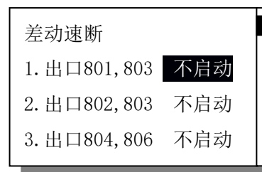
跳闸矩阵修改态示意图
